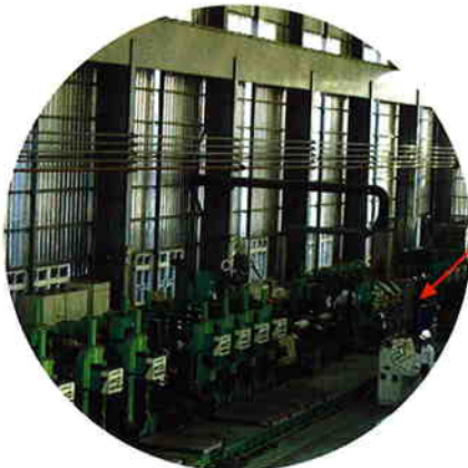
大口徑製管機 Large diameter pipe mill
